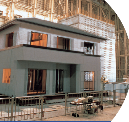
実験住宅は現実的な間取りとしました。 ※偏りが比較的大きく、耐震実験には不利な間取りで実験
